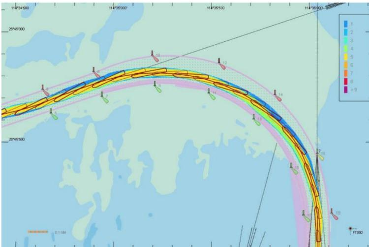
Cette illustration montre le résultat d'une simulation accélérée où un navire de croisière a entrepris plusieurs passages à partir d'un port. Une trace réelle est affichée au-dessus de la zone balayée pour toutes les simulations.
