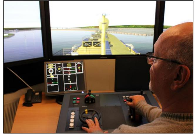
Figure 4 Vue extérieure du système multi-écrans et du boîtier de commande externe
